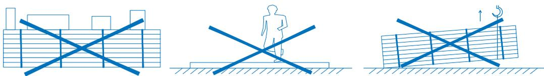
Складирование пакетов панелей необходимо производить на подкладках не более чем в два яруса, а отдельные панели – в штабелях высотой не более 1,5 м.
